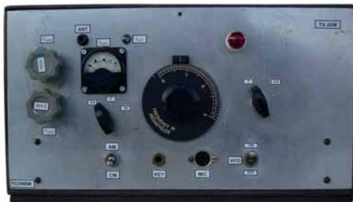
Oddajnik 20 W za frekvence 3,5, 7 in 14 MHz
