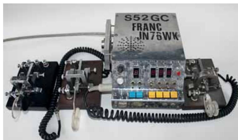
Doma izdelane ročice in elektronsko tipkalo s spominom
